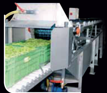
Immersion salad boxes washing Chaîne de lavage par trempage monoligne
